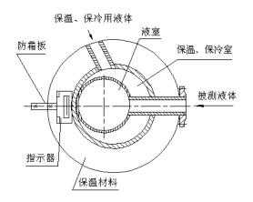
防霜型液位计主要用于在低温下(一160℃~-20℃)使用时,液位计本体及显示窗会凝聚空气中的水蒸气而覆盖上厚厚的霜层,致使从显示窗视窗看不见显示,造成无法 观测液面,在这种场合,可在显示器前,加装丙烯基保护窗,整体装保温材料.这样就可通过保护窗,观察到正确液位。
