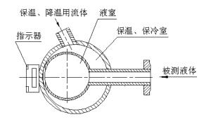
夹套型磁浮液位计主要用于高粘度或低沸点的液体。高粘度易凝固液体在夹套内通热蒸汽或高温液体,使液室内温度与储罐相同来获得准确液位。低沸点易沸腾液体,在夹套内通冷却水来稳定液面获得准确液位。为保证某些特别严格场合的应用,伴热或保冷夹套我厂产品可从法兰处开始。此时也可采用我厂特制阀门,以减少热量的交流。
