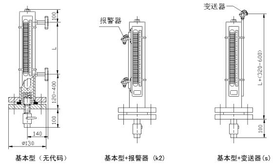
5.2 E型、F型、D型:为适应现场的安装接口的特殊性,可根据具体情况选用如下的安装方式:
