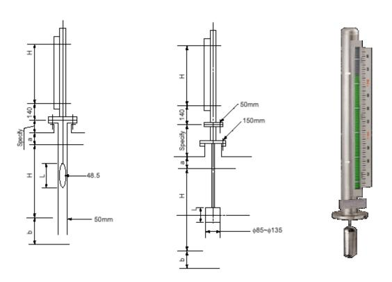
当被测液面波动较大或测量范围很大时,可加装防波管(我厂可提供),以防止连杆弯曲。安装时,要确保测量导管与防波管在一个轴线上。液位计可配置报警器或变送器,用以实现液位信号的远传报警或显示。特别适合于地下卧罐、槽等的液位显示。一些特殊的腐蚀场合可采用工程塑料制造,如稀盐酸,碱液等。参见 6.4
