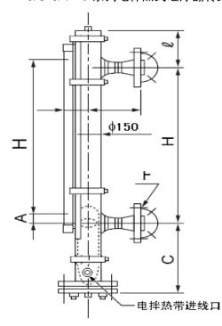
电伴热式磁浮翻转式双色液位计主要用于在环境温度较低 (-40℃~-20℃)使用时,现场没有蒸汽伴热,在这种场合,可以采用电拌热。
