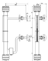
6. 6. 2补偿值误差:见下图中的A 值及文字说明,由于设计浮子时得不到现场的实际数据,会造成给定的A 值与实际值的偏差,正常运行后,通过现场的实测可以消除。
