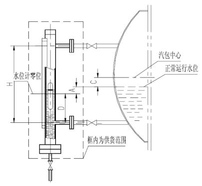
对于锅炉汽包的水位测量,下图C 为锅炉正常运行时,汽包的水位至汽包中心的距离,尺寸A 为锅炉正常运行时,液位计的显示水位低于汽包际水位的差值,具体数值随压力等级而不同。另外由于现场环境温度不同、汽、水引出管长短不同、有无保温等原因, A 值均存在误差, 特别是在启动初期误差更大,电厂应根据实际情况对液位计进行核对、调整。D 值为液位计零位至液位计水管中心的距离。
