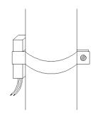
11.6.3 调试: 安装好后,用万用表测量输出状态,若液位 开关输出信号与实际相符,则无需调校即可使用:
