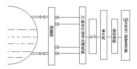
水和汽的导电性能差别极大,(以发电厂汽包为例,一般水阻在几十  $K\Omega$  左右,汽阻在几百  $K\Omega$  以上)测量筒的作用就是将水位的变化通过电接点阻值的变化,转换成电信息送至二次仪表,二次仪表进行运算和逻辑判断,最后以发光二极管和数码管准确显示出水位值。
