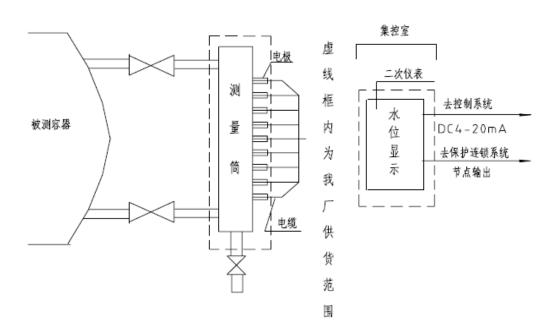
2.2 显示方式: 本装置采用热工习惯的标志,即汽红、水绿的双色合成光柱显示, 直观地显示 汽、水位置。
