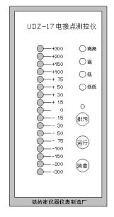
高高位报警灯:水位高于最高设定点时,亮起报警,同时本机蜂鸣器声音报警; 高位报警灯:水位高于高位设定点时,亮起报警,同时本机蜂鸣器声音报警; 低位报警灯:水位低于低位设定点时,亮起报警,同时本机蜂鸣器声音报警; 低低位报警灯:水位低于最低位设定点时,亮起报警,同时本机蜂鸣器声音报警;
